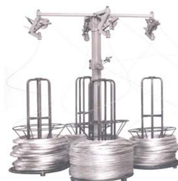
D4B Odvíjení se čtyřmi rameny pro čtyři rámy (nosiče)
